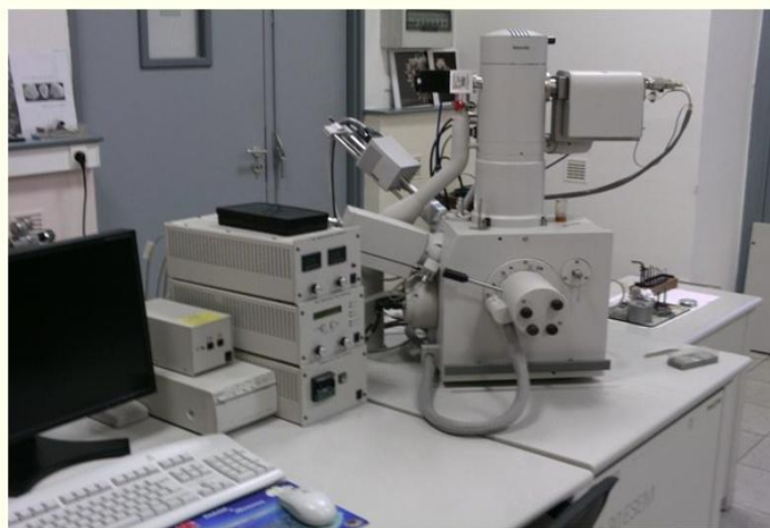
Figure II-5 : Microscope électronique à balayage couplé à un analyseur élémentaire EDX.
