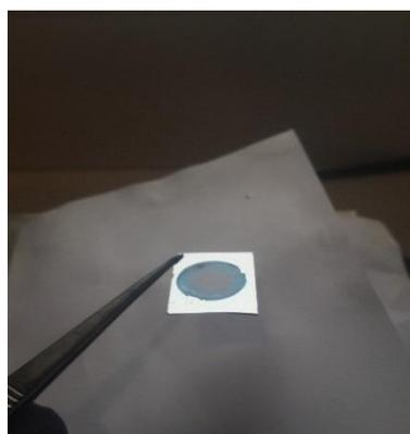
Figure II- 5 : Echantillon de SiP oxydé après greffage de PPy.
