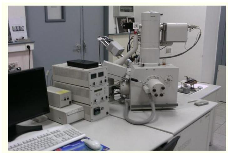
*Figure II- 6 : Microscope électronique à balayage*
