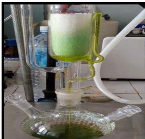
**Figure IV-4 : Dispositif d'extraction par soxhlet**
