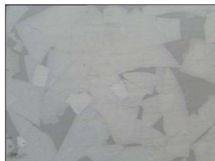
Les cristaux \text{CaCO}_3 avec 10 ppm d'inhibiteur (Grossissement 12.5)
