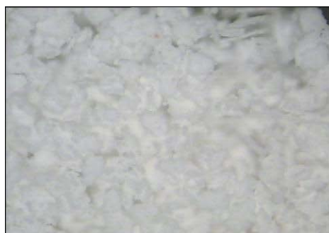
Les cristaux de \text{CaCO}_3 sans inhibiteur (Grossissement 12.5)
