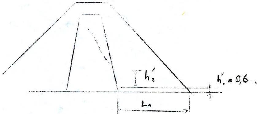
Si nous représentons par  $h'_1$  la hauteur de la ligne de saturation au pied aval du massif (0,6m), par  $h'_2$  la différence de niveau que présente la ligne de saturation entre l'amont et l'aval de la zone perméable pour  $L_1$  la longueur de ce massif et par  $K'$  la perméabilité du matériaux ( $1 \cdot 10^{-1}$ ), nous pourrions écrire :
