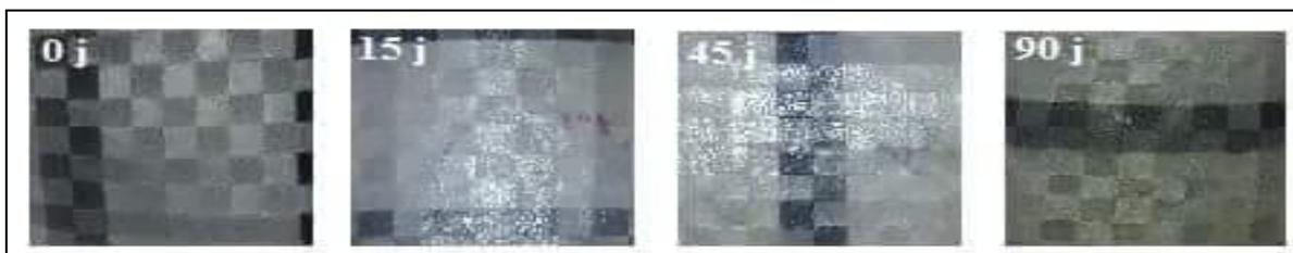
**Figure 6-19 :** *Changement des propriétés d'aspect des éprouvettes non vieillis (1% d'additif pro-oxydant 'X') pendant les 90 jours d'enfouissement*
