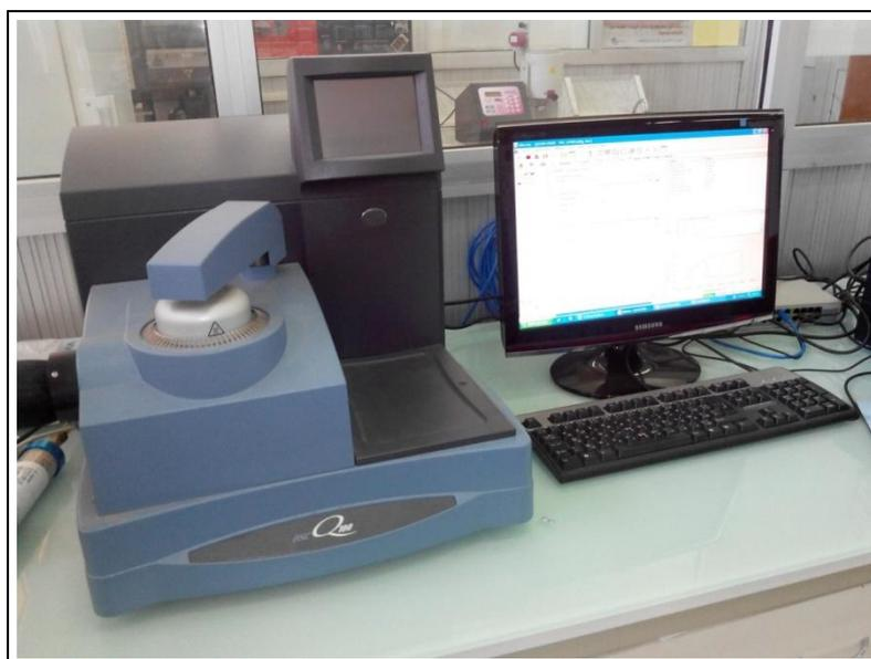
Figure 5-6 : Appareil DSC utilisé
