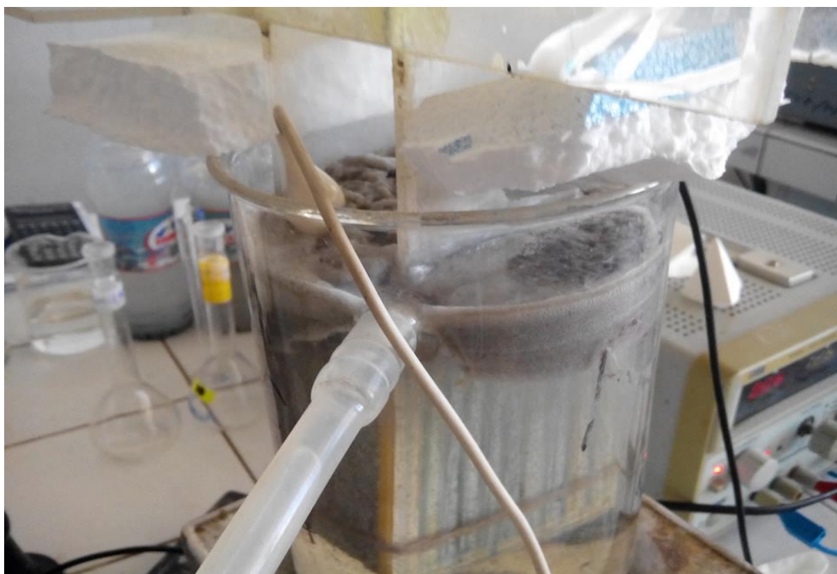
Figure 29 : Formation de floccs au cours du traitement
