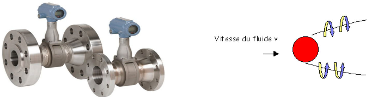
FIGURE 3.10 – Débitmètre à effet vortex.
