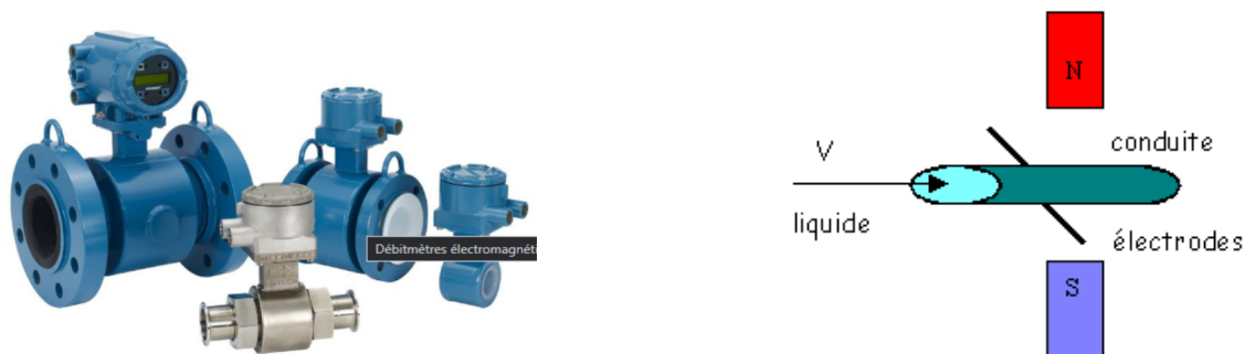
FIGURE 3.7 – Débitmètre électromagnétique.
