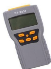
FIGURE 3.16 – Tachymètre électronique et son schéma.
