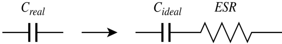
Figure 2. 9. Resistance série équivalente ESR d'un condensateur.
