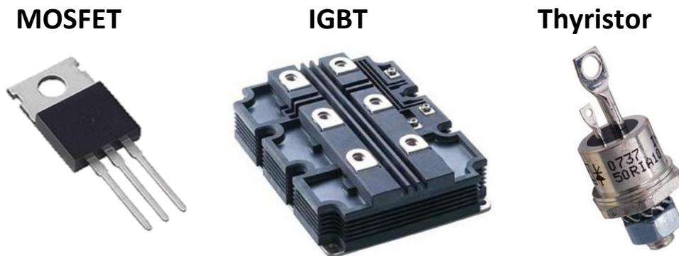
Figure 1. 6. Interrupteurs électroniques à base de semi-conducteur.
