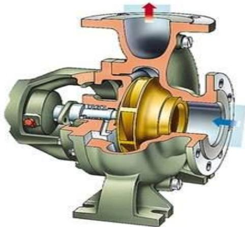
Figure I.1 Image d'une pompe centrifuge
