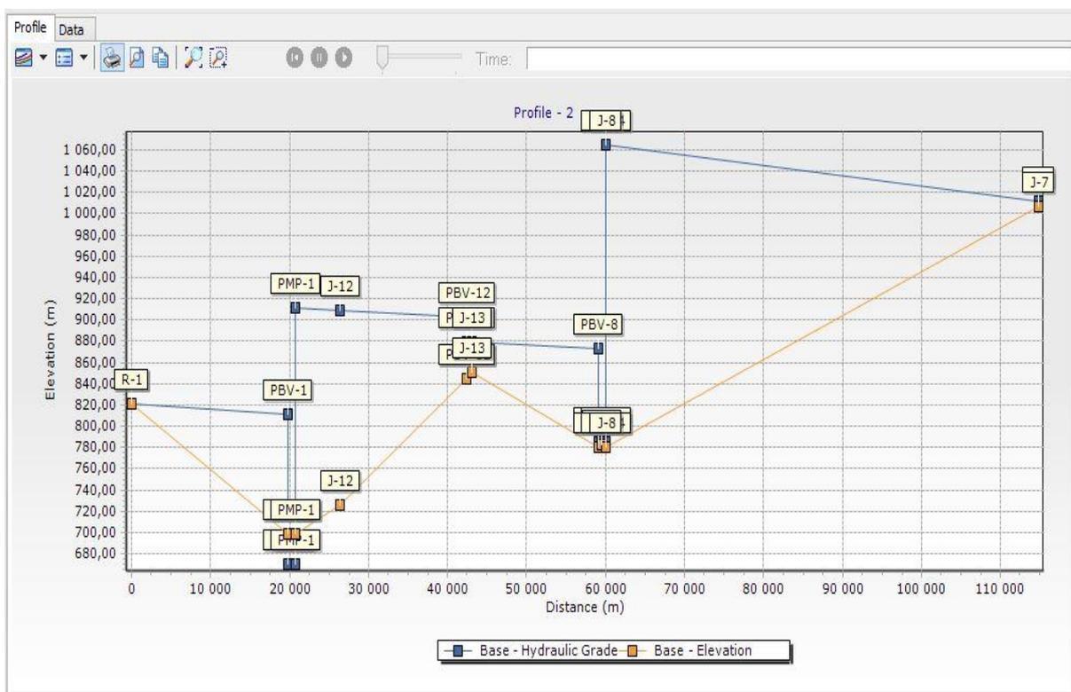
Figure III. 6: Profile de la 2<sup>eme</sup> conduite par WaterCAD
