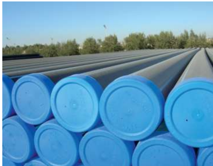
Figure I. 6 : Des conduites PEHD en bars
