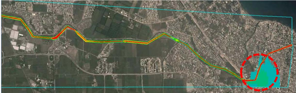
**Figure V.11 :** Etendue de la crue sur terrain avec construction à 36000 s
