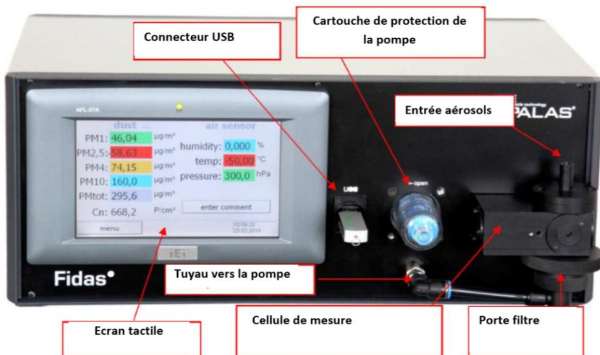
Le flux d'air passe ensuite par une cartouche filtrante protégeant la pompe de prélèvement. La tension d'alimentation de la pompe est réglée par rapport à une mesure du débit de prélèvement par un débitmètre massique, pour ajuster un débit de 4,80 l/min aux conditions standards de 1013 mbar et 25°C. La concentration massique calculée par l'analyseur est ramenée aux conditions volumiques selon la température et la pression ambiante fournies par la sonde météorologique.
