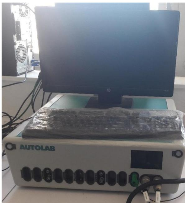
*Figure II.2 : Potentiostat AUTOLAB*
