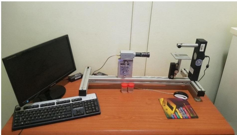
**Figure II.6 :** *Dispositif de mesure de l'angle de contact*
