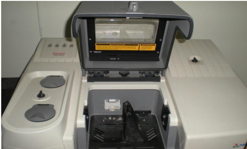
**Figure II.5 :** *Spectromètre Infrarouge à Transformée de Fourier.*
