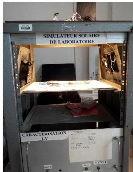
*Figure II.7 : Simulateur solaire de laboratoire*
