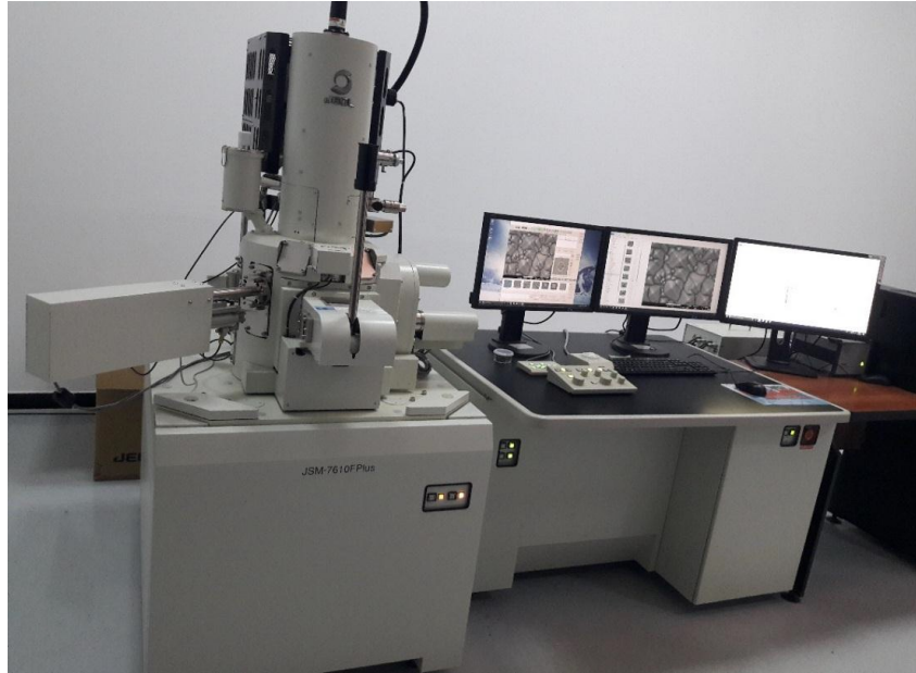
FIGURE 2.7 – Photographie de l'appareil MEB JEOL équipé d'un détecteur EDX.
