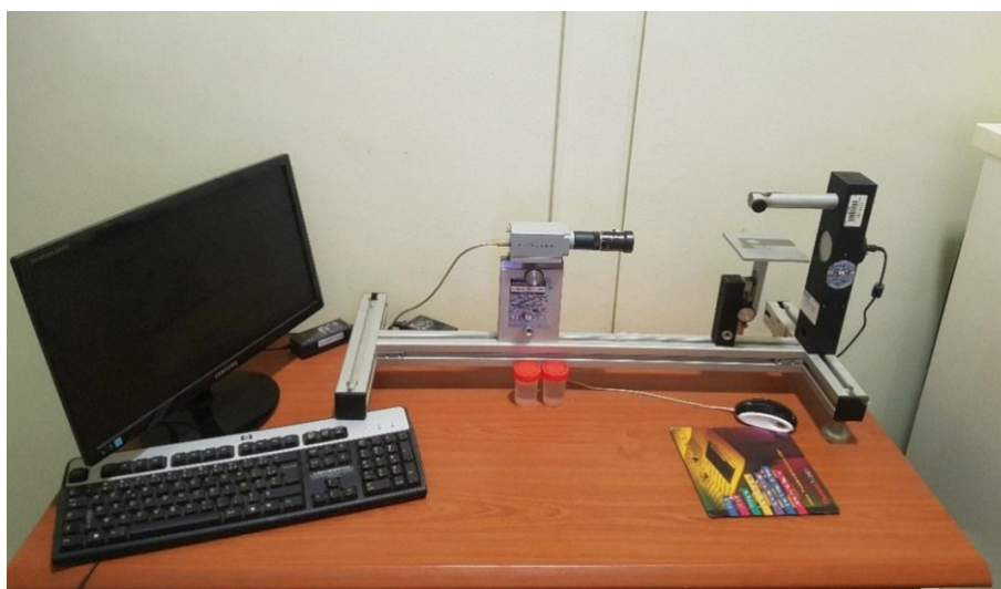
FIGURE 2.10 – Dispositif utilisé de l'angle de contact.
