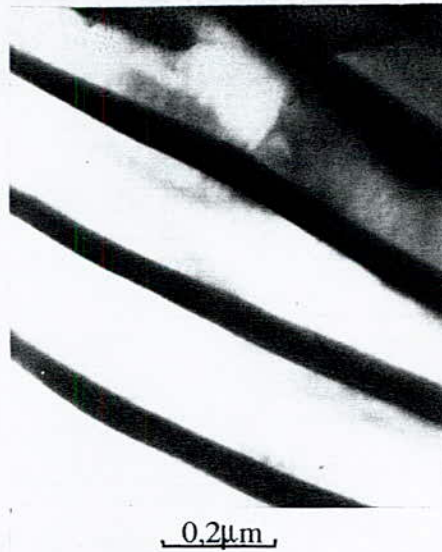
Figure IV-35 : Observation de la perlite sur le cordon de soudure par microscopie électronique ( G = 75000 .) à l'état recuit.
