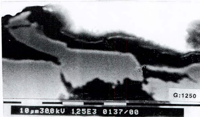
Figure II-67-d : Micrographie prise au MEB sur le profil transversal de la surface abrasée sans attaque chimique de la fonte V3 ayant subi le traitement bainitique avant usure.
