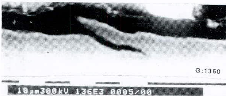
Figure II-67-c : Micrographie prise au MEB sur le profil transversal de la surface abrasée sans attaque chimique de la fonte M3 ayant subi le traitement bainitique avant usure.
