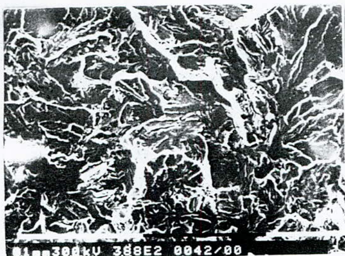
Figure IV-33 : Microfractographie d'un soudage de la fonte GSC avec l'AFA à l'état recuit du soudage sur le cordon après l'essai de traction.
