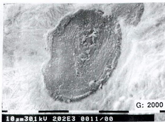
Figure II-53 : Initialisation de l'usure sur la fonte M3 bainitique .
