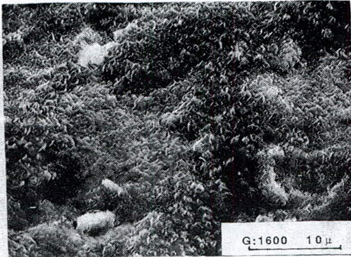
Figure II-58: Micrographie prise au MEB de la fonte M3 après traitement bainitique et après usure pendant 40 000 tours .
