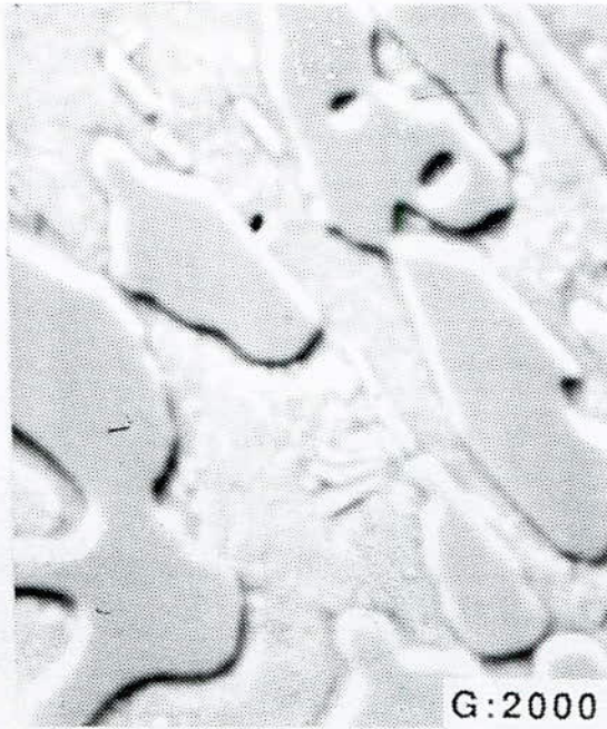
Figure II-21-a: Image par électrons rétrodiffusés de la fonte C2B
