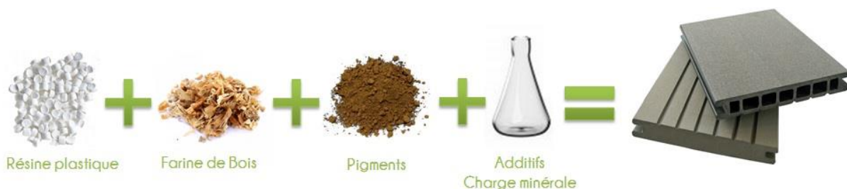
Figure 3.2 : les composés du bois composite [21]
