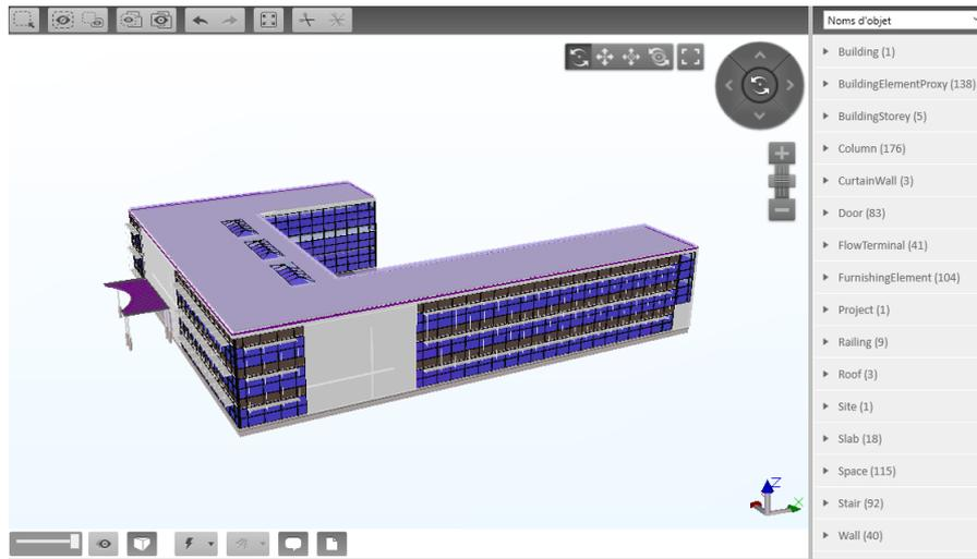
Figure 1.1 : Vue d'un modèle BIM 3D, avec les informations sémantiques
