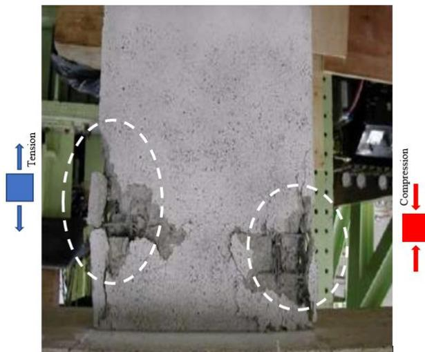
Figure 4.5 : Modes de ruine sur un essai réel
