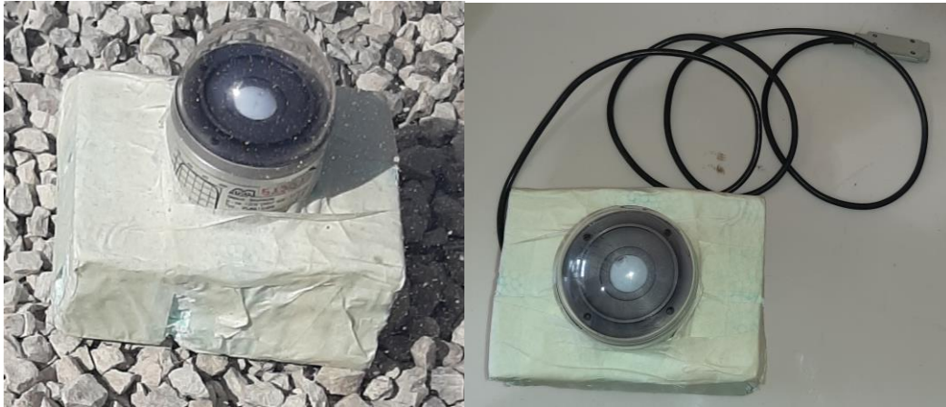
Figure V.15. Pyranomètre utilisé dans l'expérimentation.
