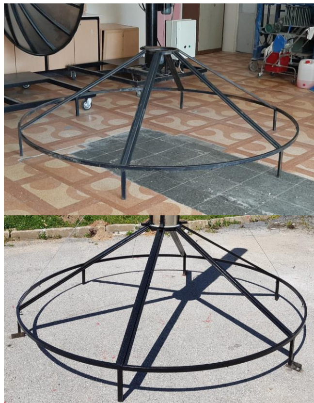
Figure V.2. Support métallique avant augmentation de la surface.
