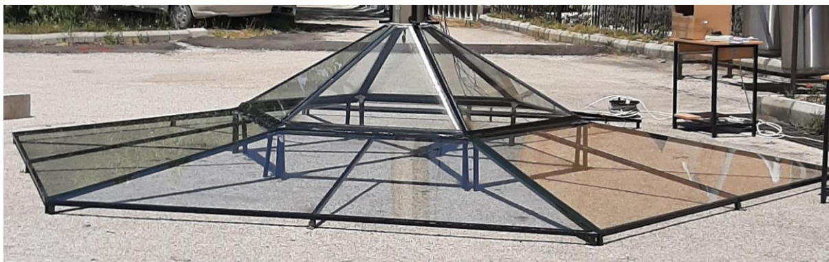
Figure V.3. Support métallique et le collecteur en verre après augmentation de la surface.
