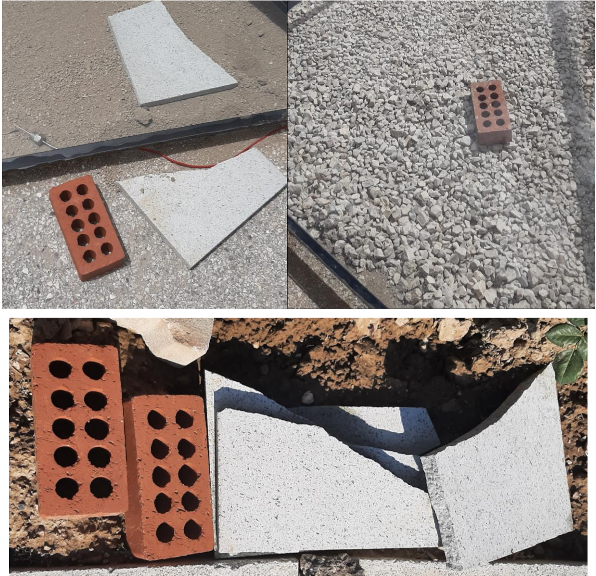
Figure V.14. Pierre en granit et brique rouge déposé à l'intérieur et à l'extérieur du collecteur.
