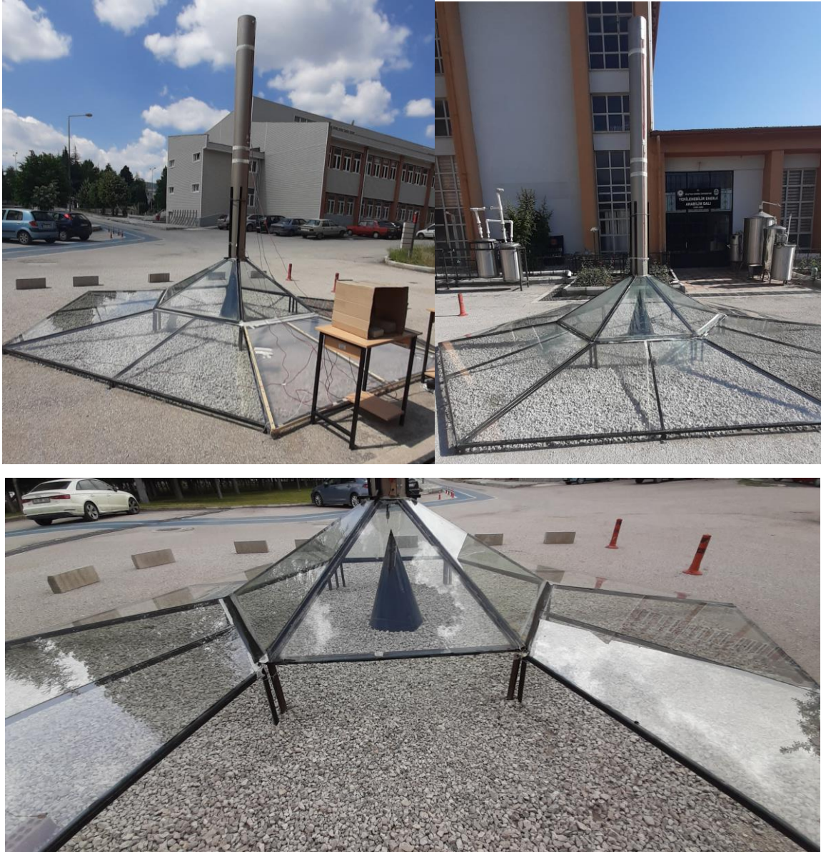
Figure V.13. Cheminée solaire avec gravier comme système de stockage thermique.
