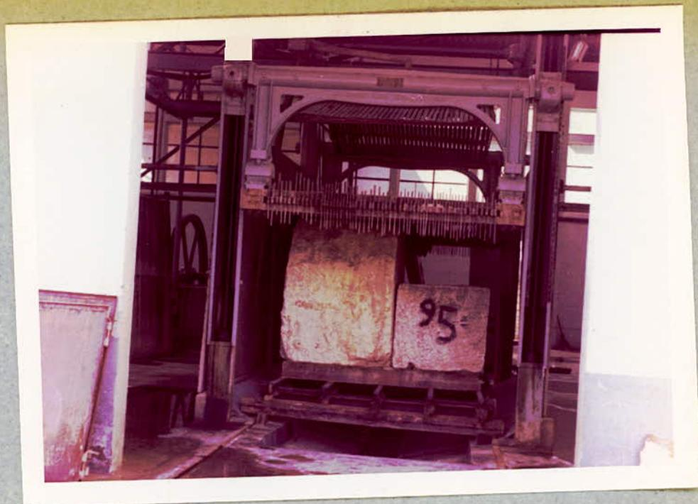
photo (14) : Déficit d'un remplissage du Chassis
