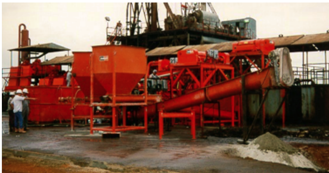
FIG. 4.10 : Unité de solidification-stabilisation [5]
