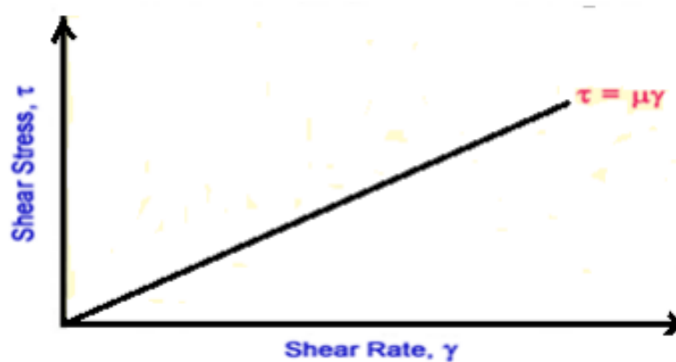
FIG. 1.8 : Rhéogramme d'un fluide newtonien [10]
