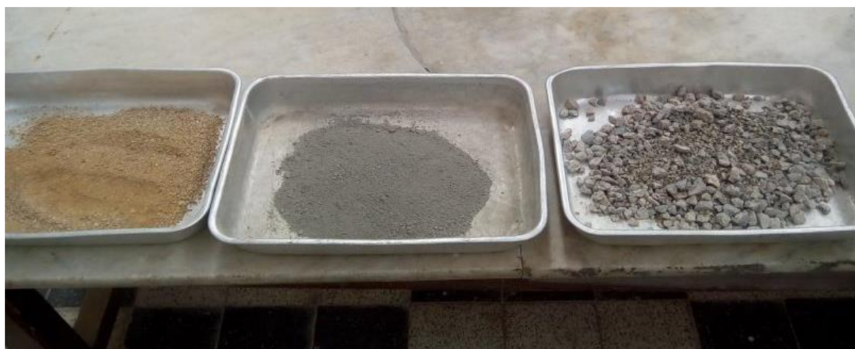
Figure 75: Ingrédients après pesée pour une confection de béton
