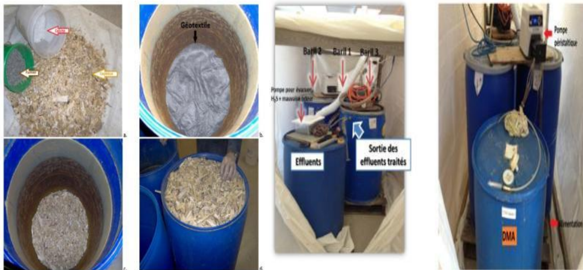
Figure 15 : Etapes de construction d'un BPSR : a. différents composants du mélange, b. vue de l'ensemble du système de traitement de DMA (Lounate, 2019)
