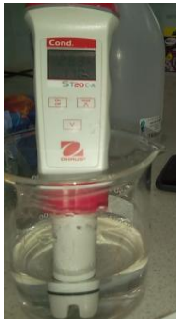
Figure 69: Mesure de la conductivité des lixiviats par un conductimètre de type OHAUS ST 20 C-A.
