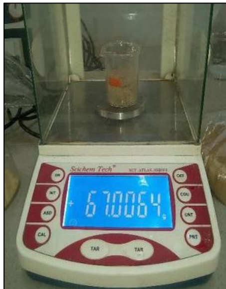
Figure 72 : Préparation d'échantillon pour MCA (pesée de 67g)
