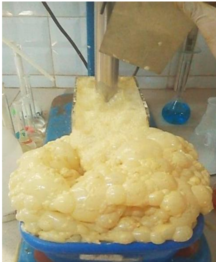
Figure 57 : Flottation principale des rejets zincifères de Sidi Kamber
