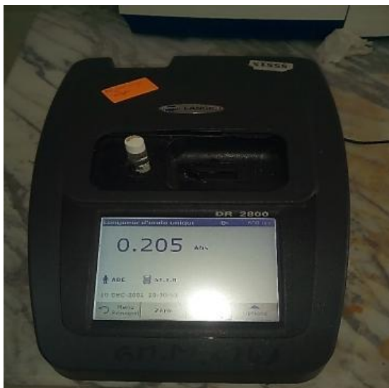
Figure 62 : Mesure de la densité optique par un Spectrophotomètre de type DR2800
