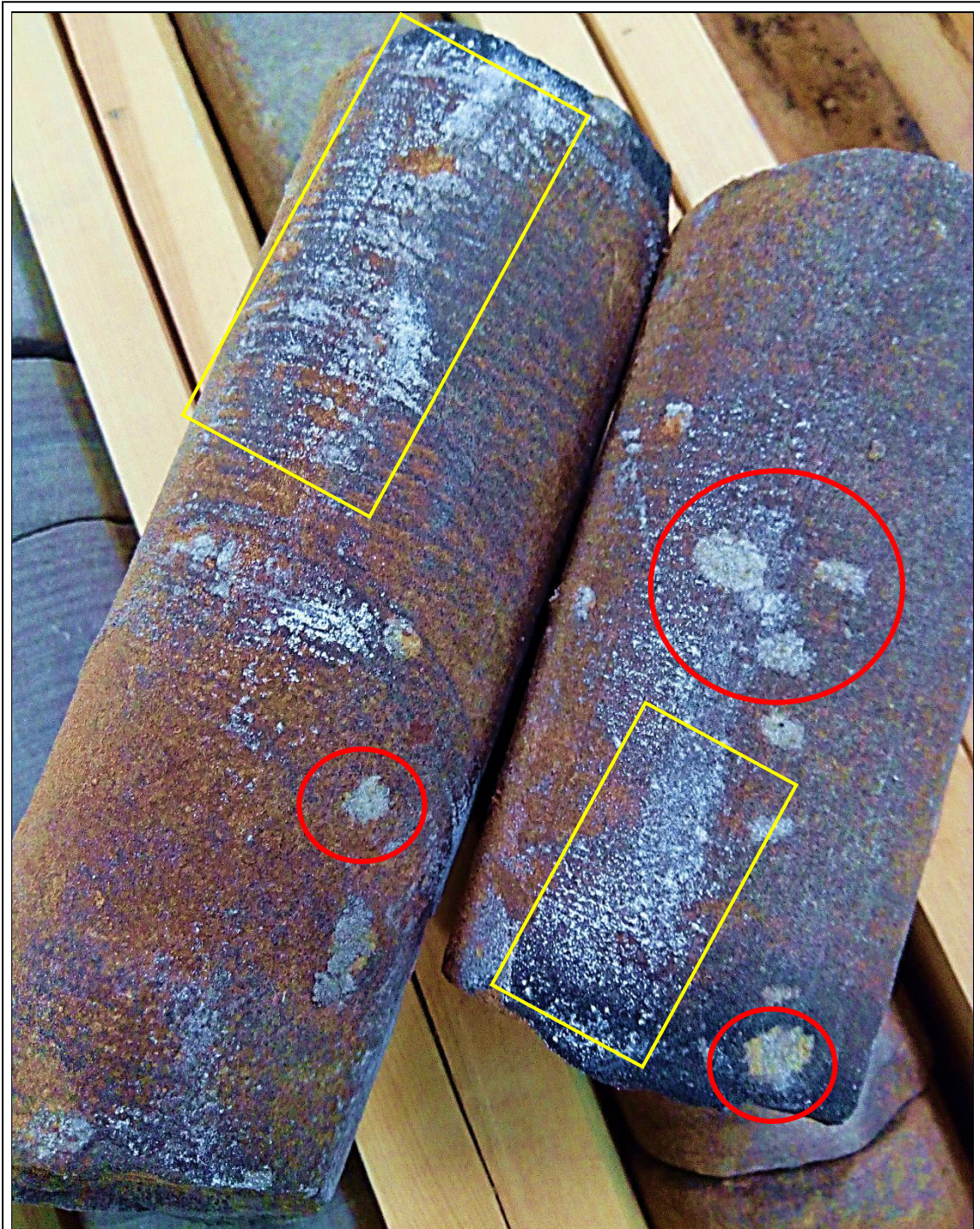
Figure 4.15 : Une carotte de grès à ciment salifère (Oued Mya. Unité T2A, Division Exploration Sonatrach)
