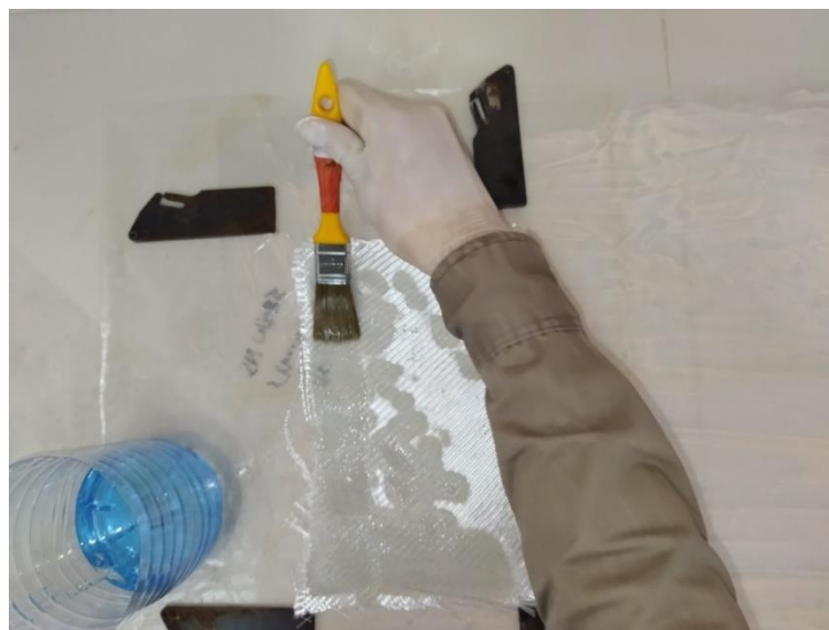
Figure 51: Imprégnation des tissus en résine.
