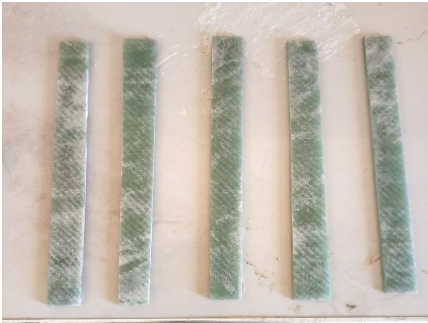
Figure 54: Eprouvettes de matériaux composite obtenues après le découpage de la plaque élaborée.
