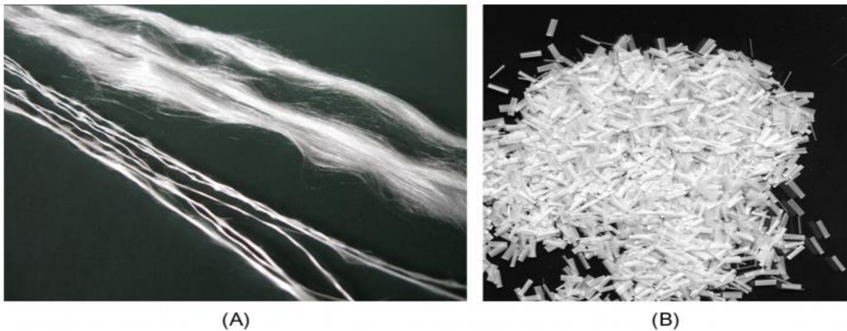
Figure 31: (A) Fibres de verre en longueur continue et fibres de verre coupées, communes à l'industrie plastique (B) Fibres de verre coupées.
