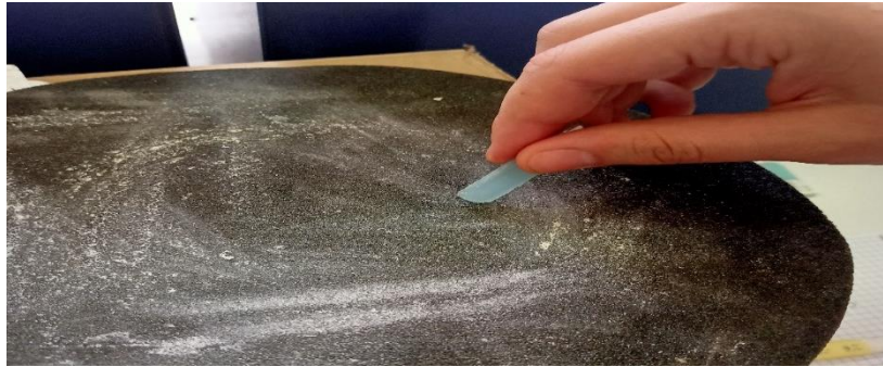
Figure 47 : Ajustement des éprouvettes par un papier verre.
