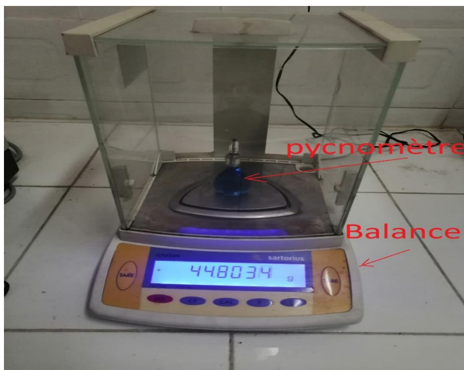
Figure 34: Pesé de la résine à l'aide de la balance.
