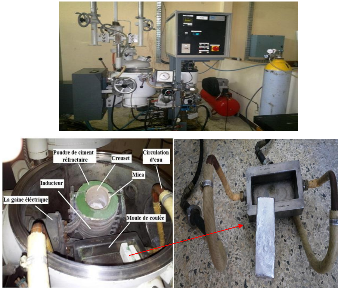
Figure III.1 : four de fusion à induction LEYBOLD-ISO1 et l'intérieur de l'enceinte du four.
