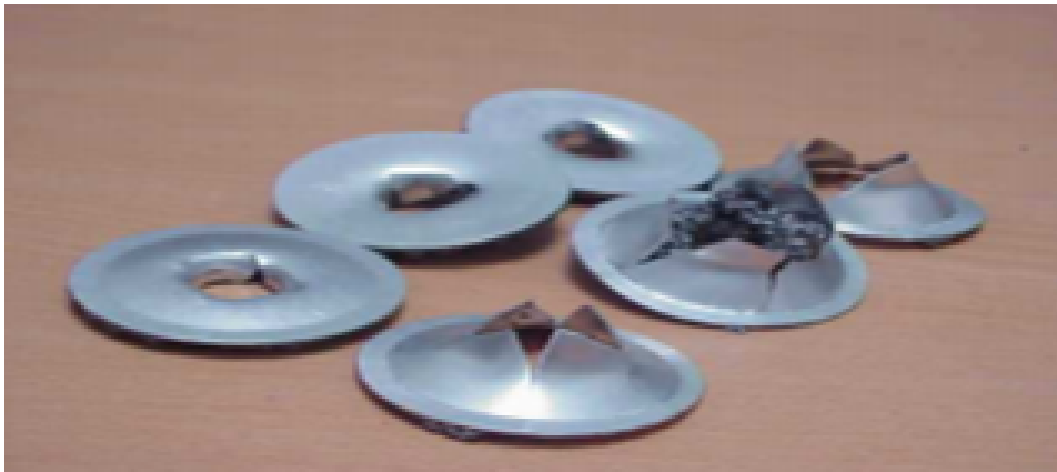
FIGURE 2.5 – Photographies de post-perforation dynamique de la plaque incidente (les 3 peaux à gauche) et de plaque secondaire (les 3 peaux à droite)
