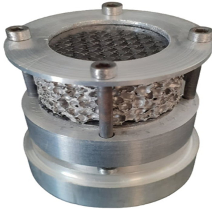
FIGURE 3.25 – Photographie du support de l'essai quasi-statique
