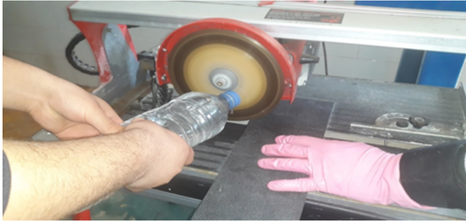
FIGURE 3.10 – Découpage des éprouvettes
