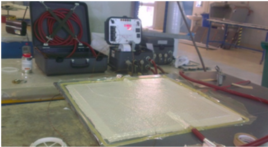
FIGURE 3.8 – L'opération sous vide
