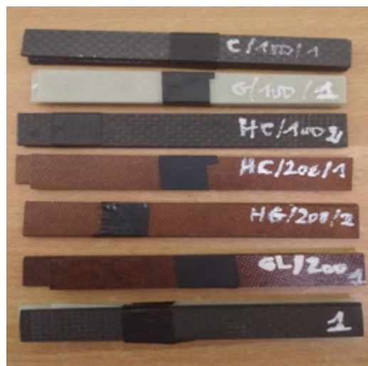
FIGURE 3.27 – Les éprouvettes destinées aux essais de flexion
