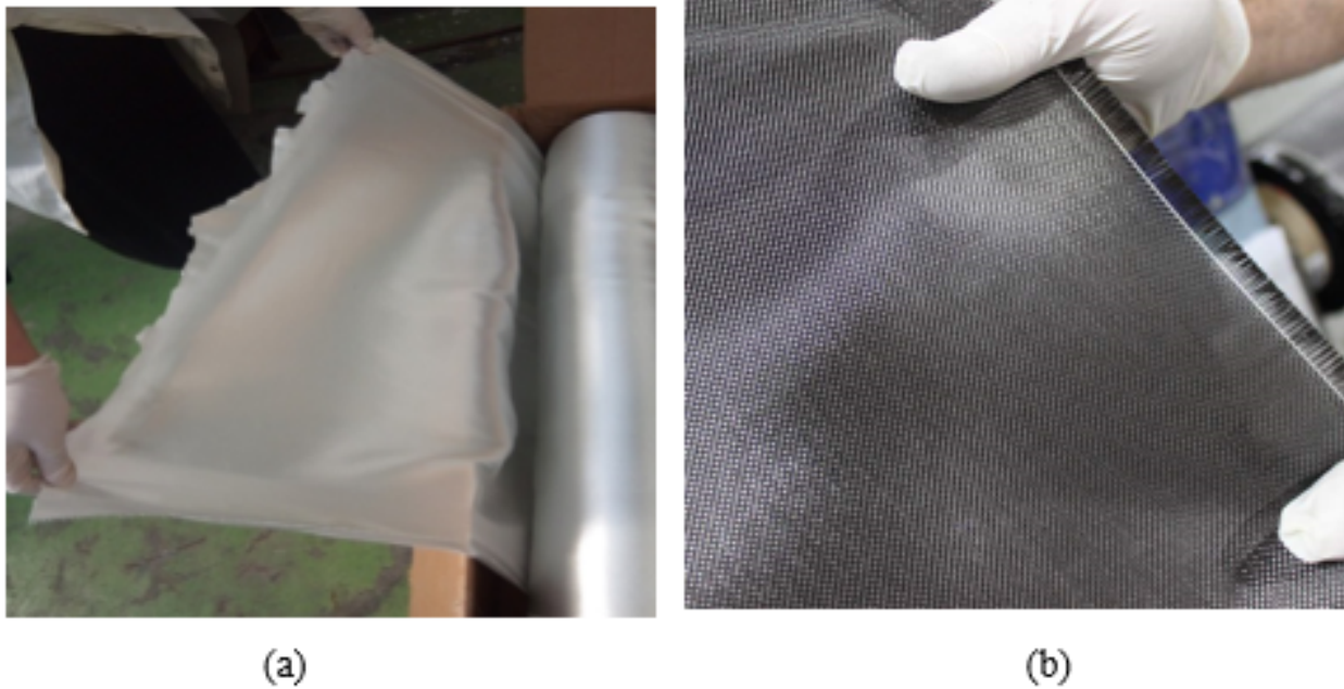
FIGURE 3.2 – Renfort utilisés : (a) tissu de verre (b) tissu de carbone
