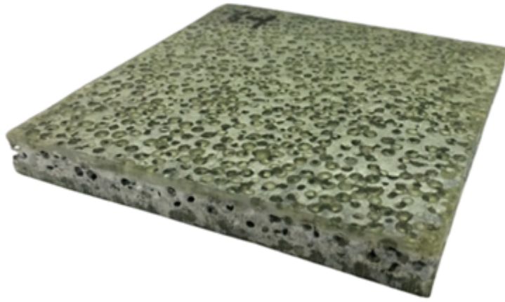
FIGURE 2.10 – Schéma du panneau sandwich [45]
