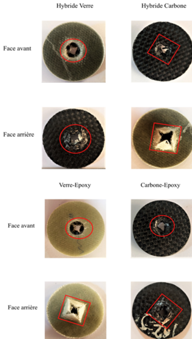
FIGURE 4.2 – Modes de rupture des stratifiés sous perforation quasi-statique
