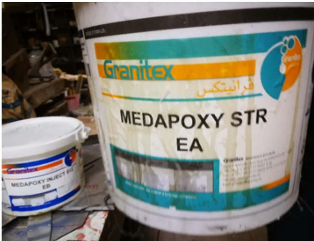
FIGURE 3.1 – Résine MEDAPOXY et durcisseur utilisée pour l'élaboration des stratifiés.
