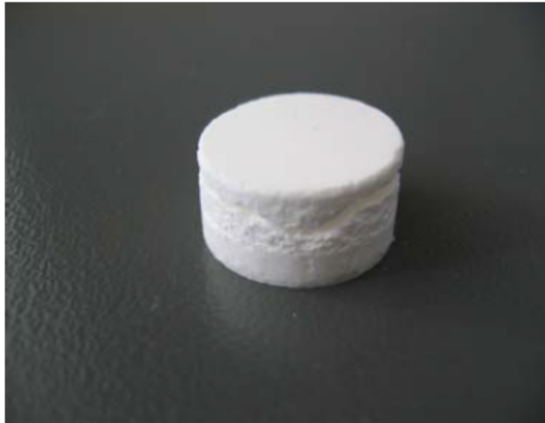
Figure 1.10 – Clivage d'un compact de lactose après éjection [11].
