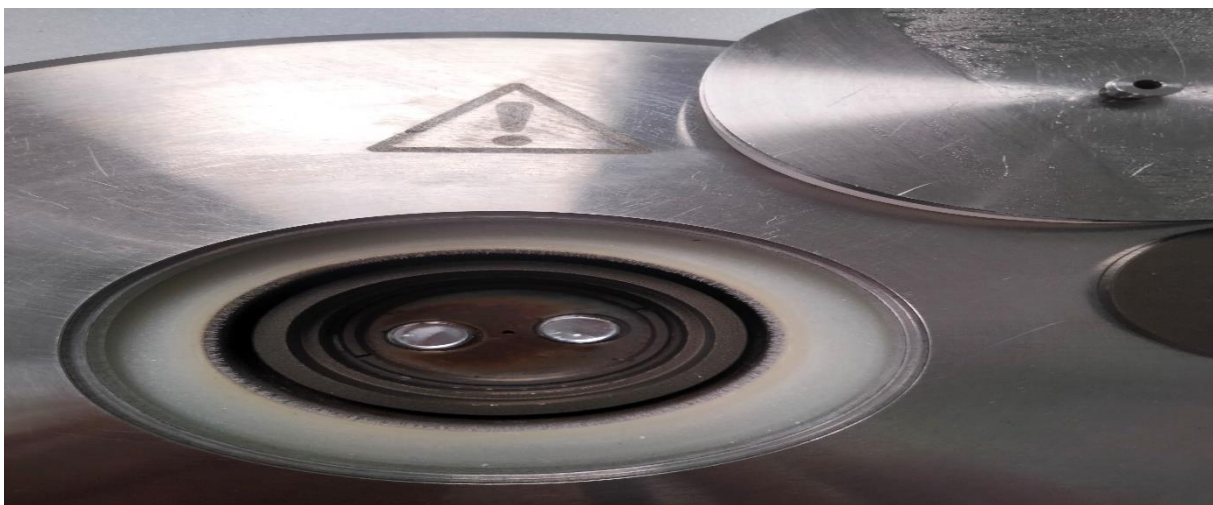
Figure 3-15 : Disposition des creusets dans le four de la DSC : le creuset contenant l'échantillon à gauche et le creuset de référence à droite.
