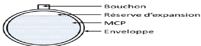
Figure 1-7: une capsule de macro-encapsulation [24].
