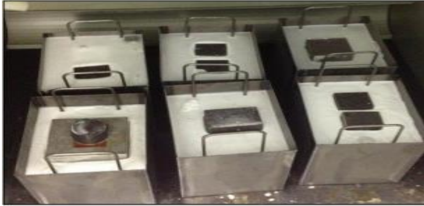
Figure 1-5: Incorporation de la paraffine dans des plaques de graphite naturel expansé [12]
