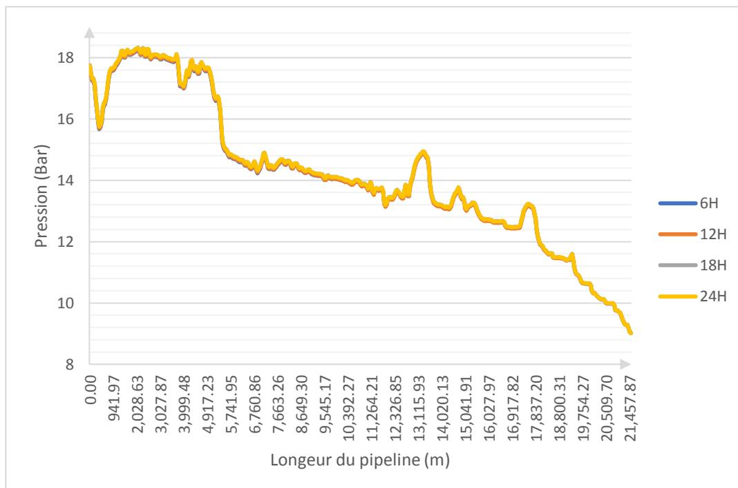
**Figure 4.34** : Variation de la pression  $P_T$  en fonction de la longueur du pipeline à  $t = 6\text{h}, 12\text{h}, 18\text{h}, 24\text{h}$  pour  $T = 40,1^\circ\text{C}$ .
