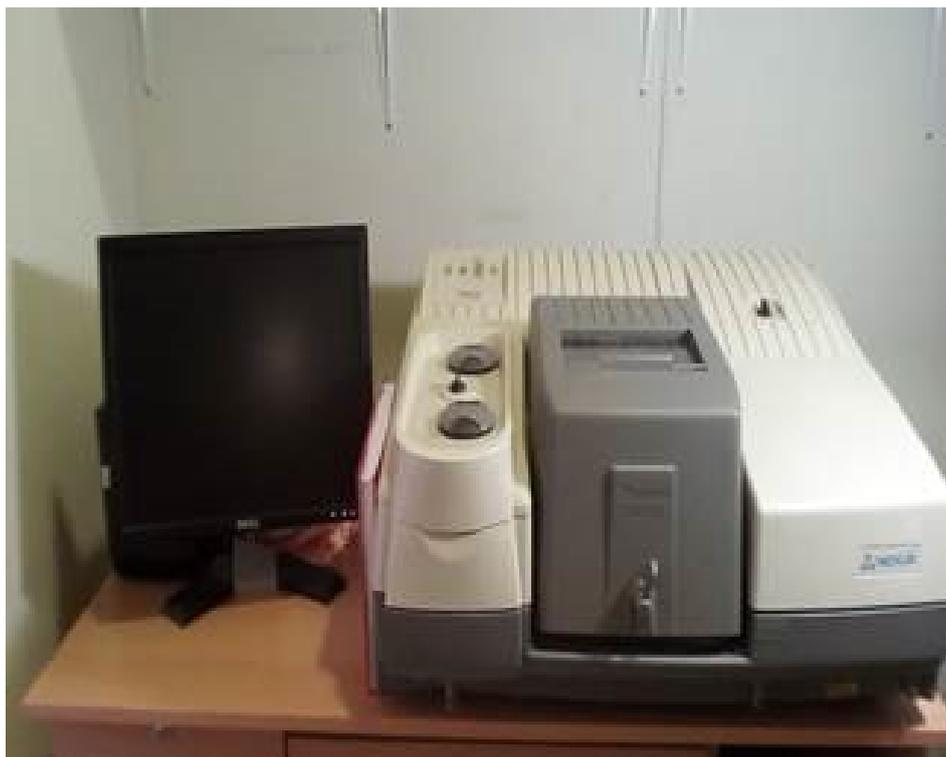
FIG. B.3 : Spectroscopie Infrarouge à Transformée de Fourier (FTIR/ATR) Thermo Nicolet NEXUS 670.
