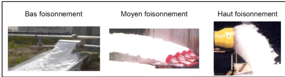
Figure 2-4 : Différents types de foisonnement de la mousse [INERIS,2016]
