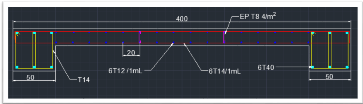
Figure 6.17 : Schéma de ferrailage du voile au niveau RDC
