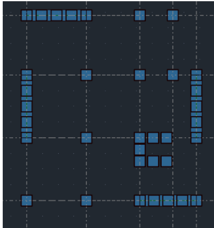
Figure 3.7 : Disposition des voiles du bloc A
