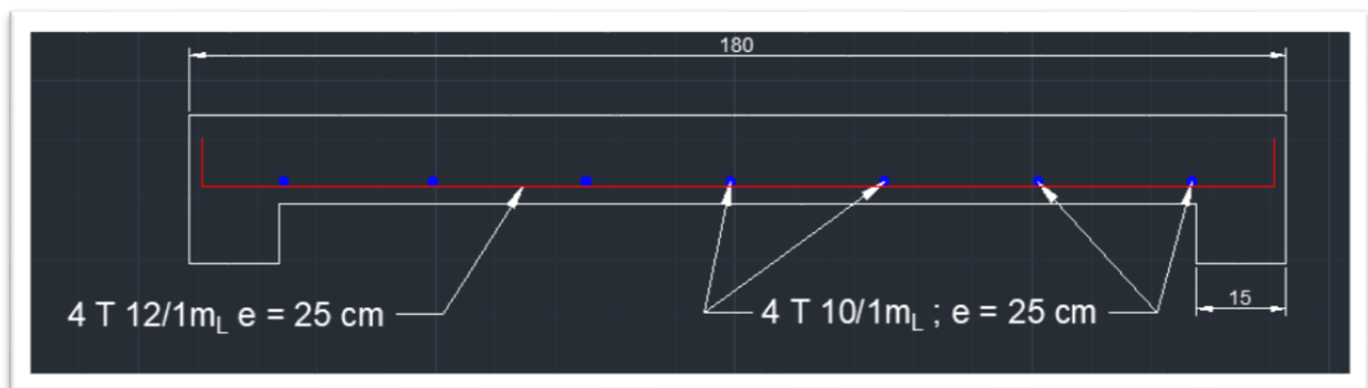
Figure 4.23 : Schéma du ferrailage de la dalle pleine de d'ascenseur (coupe parallèle à L_x )
