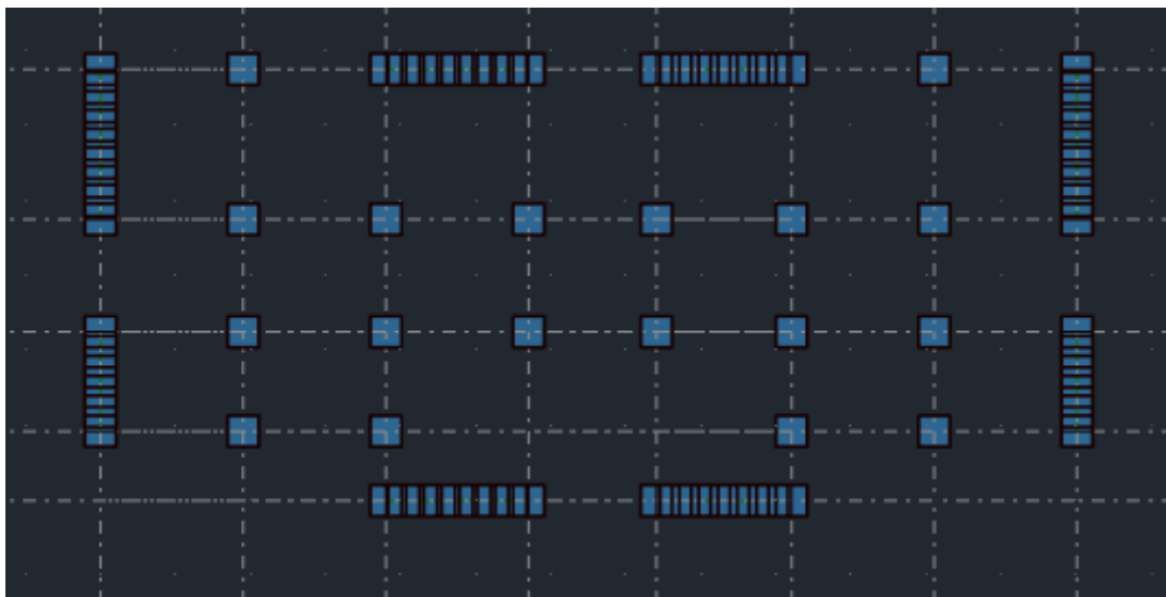
Figure 3.8 : Disposition des voiles du bloc B
