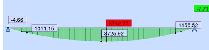
Figure V- 5: Moment fléchissant dû au poids propre de la poutre + dalle
